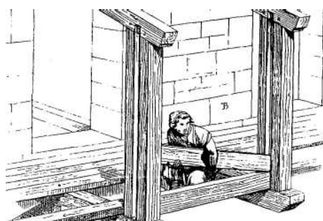
Montaje de un andamio defensivo, según la Encyclopédie Médiévale, de Viollet le Duc.
